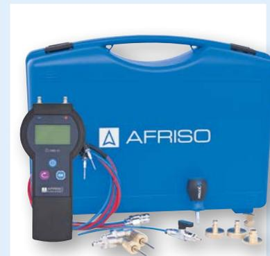
**Anwendung** Zur Messung von Differenzdruck und Einregulierung des Durchflusses in Heizungs- und Kälteanlagen im Rahmen des hydraulischen Abgleichs. Zu verwenden in Kombination mit VarioQ-Thermostatventilen und -kombiblöcken. Bei Einsatz von VarioQ-Ventilen kann der hydraulische Abgleich direkt am Heizkörper durchgeführt werden. Die Kenntnis des Rohrleitungsnetzes ist hierfür nicht notwendig, aufwändige Berechnungen entfallen.
