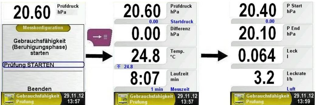
Am Ende der Druckmessung ertönt ein Signal und in der Hauptanzeige wird das Ergebnis angezeigt. Die Messwerte werden in der Hauptanzeige festgehalten und man kann das Messprotokoll versenden (App), ausdrucken (BlueLine Messgerät) oder abspeichern (BlueLine Messgerät).
